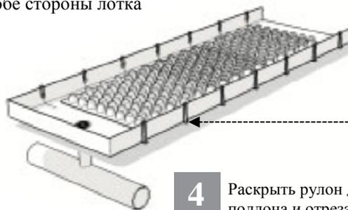
**4** Раскрыть рулон дренажного поддона и отрезать необходимую длину. Согнуть боковины по разметке, закрепить их помощью держателей-клипс Г-образной формы и уложить на дно поддона дренажный разделительный лист.
